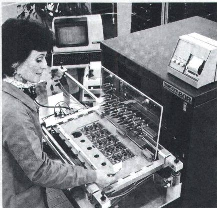
Für die Zwischen- und Endkontrollen werden heute «In-line-inspection»-Automaten eingesetzt. Ihre Verwendung setzt vom Anfang der Planung an eine entsprechende Gestaltung der Elektronik voraus.
