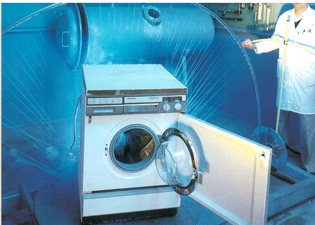
Spritzwasserprüfung einer Waschmaschine
