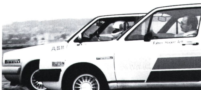
Zwei «CitySTROMer» gehen an den Start: im Hintergrund der letztjährige Gewinner auf Basis der VW Jetta mit der NaS-Hochenergie-Batterie von ABB, im Vordergrund der diesjährige Sieger auf Basis VW Golf mit der neuen Nickel-Cadmium-Batterie
