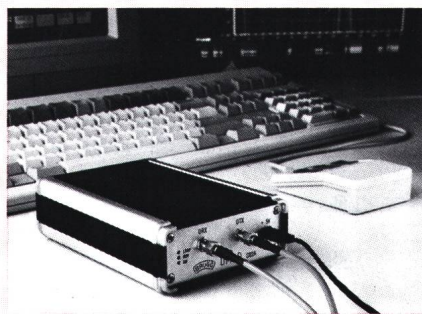
Modem für die Glasfaserübertragung
