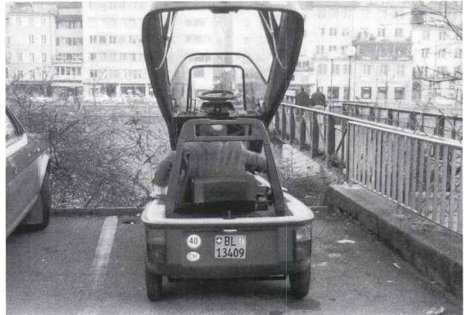
Das Ein- und Aussteigen unter dem hochgeklappten Dach erfordert etwas Beweglichkeit
