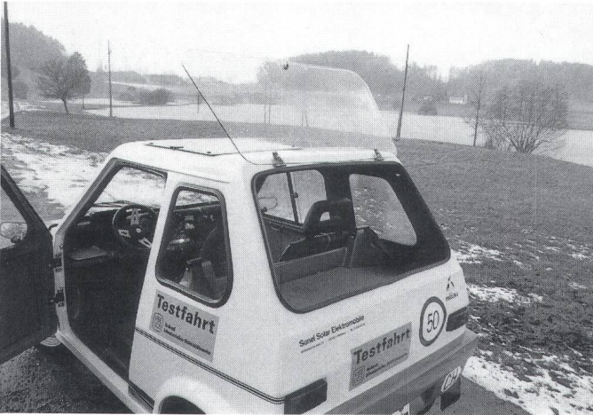
Der Gepäckraum des Pinguin 6 ist durch Hochklappen der Heckscheibe zugänglich
