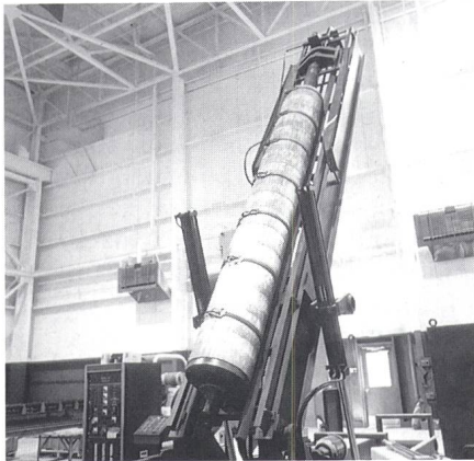
Figur 6 Titan-Ingots von 5 m Länge, hergestellt im kontinuierlichen Plasmaverfahren
