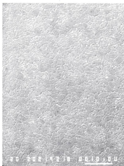
Bild 8 Fortgeschrittenes homogenes Gefüge einer Aluminiumoxid-Keramik
