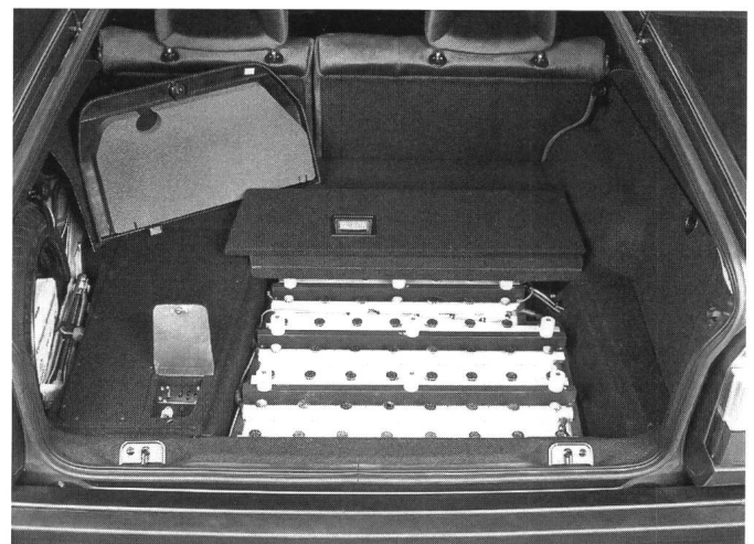
Bild 3 Die NiCd-Hochleistungsbatterie des Audi duo in der Reserveradmulde unter dem Gepäckraum
