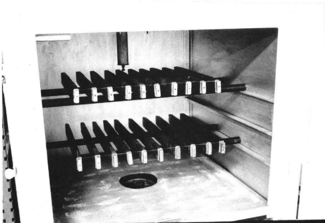
Bild 4 Alterungsöfen, mit 20 Normprüflingen bestückt
