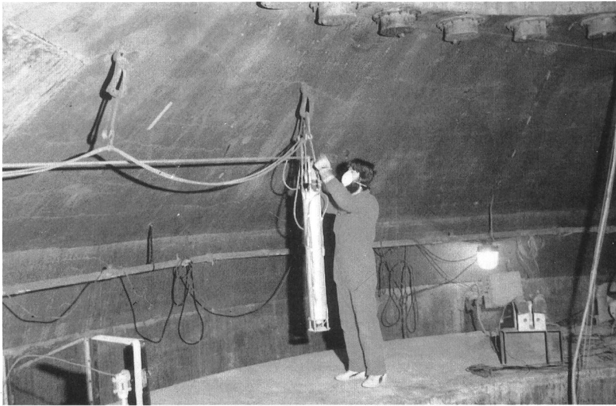
Bild 4 Für Versuche, wie sich Aerosole im Innern des Containments ausbreiten, abbauen und ablagern, steht im Battelle-Institut in Frankfurt ein Modell-Containment. Sein Durchmesser ist mit 20 Metern rund ein Drittel so gross wie der des 1200-Megawatt-Kernkraftwerks Biblis A. Bei einem Versuch zur Nachbildung der Freisetzung von Aerosolen nach einem Kernschmelzen haben sich Aerosole, hier aus nichtradioaktivem Eisenoxid, als bräunlicher Belag auf allen Innenflächen niedergeschlagen, insbesondere auf kalten.
