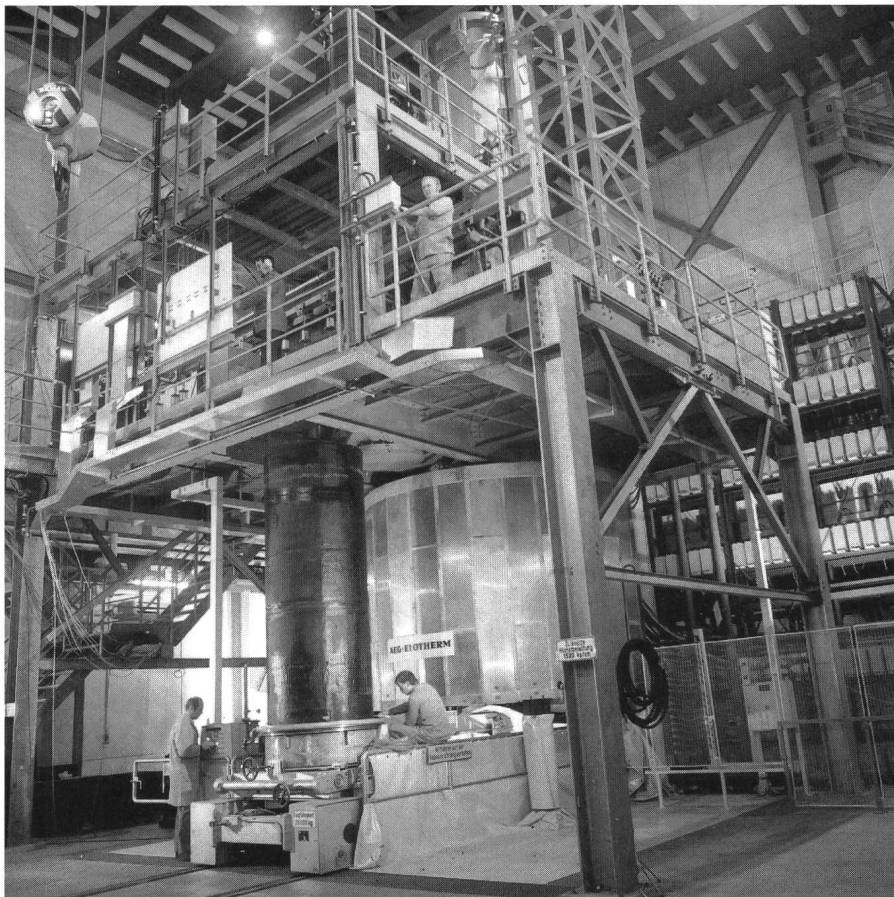
Bild 3 Das Innere von BETA: Im schwarz umhüllten Tiegel (links) «fressen» sich 600 kg einer 2400 °C heissen, nicht radioaktiven Schmelze aus Reaktorstahl bis zu einen Meter tief in Reaktorbeton. Durch die 5 bis 7 Meter starken Betonfundamente deutscher Druckwasserreaktoren würde die Schmelze frühestens nach 4 Tagen bis in den Erdboden vordringen und dort (infolge Kühlung durch das Grundwasser) erstarren.
