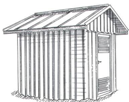
Trafo-Stationen mit Giebedach
