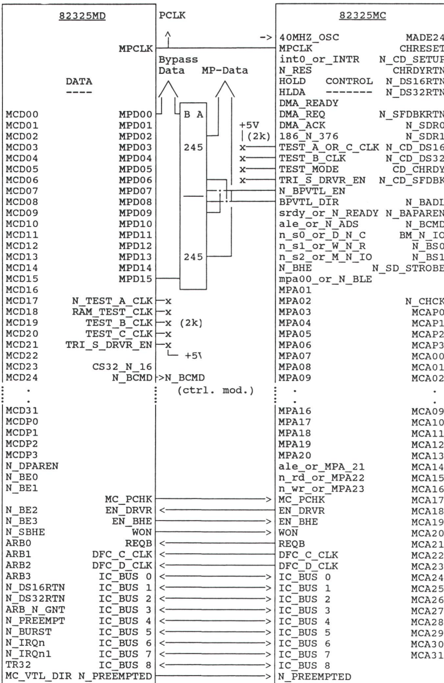
Bild 33a Der Chipsatz 82325 in seiner typischen Schaltungsumgebung
