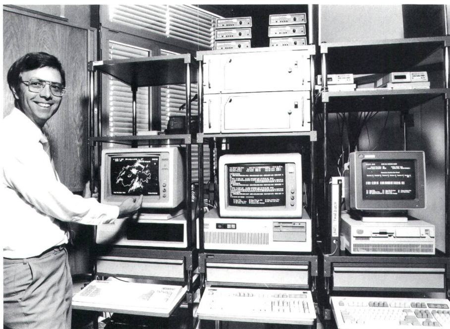
Bild 2 Messeinrichtung für die Blitzortung
