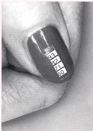
«Nagelprobe» mit Mini-CelsiStrip
