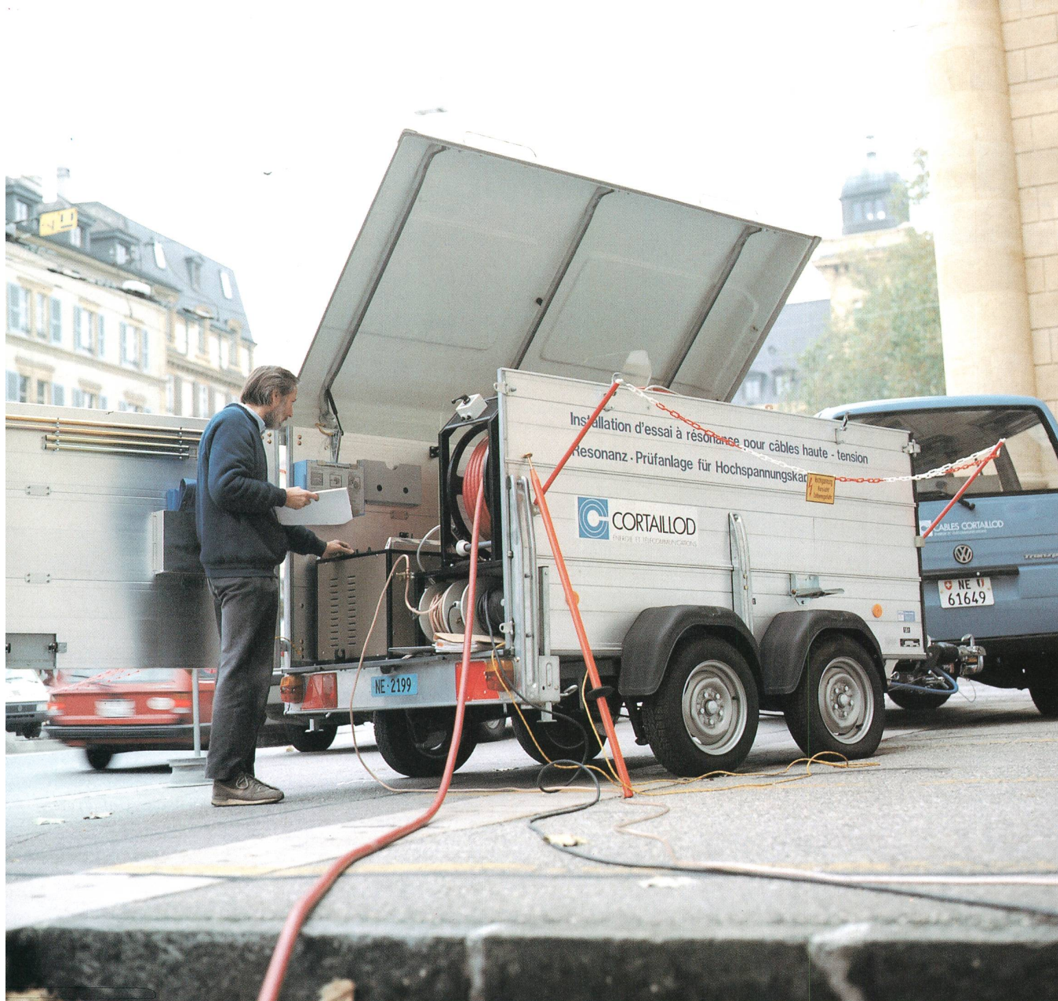
Installation à résonance pour le diagnostic sur site de câbles MT jusqu'à 36 kV.
