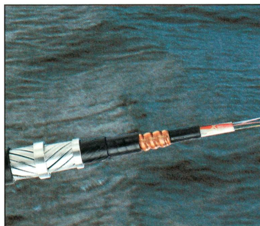
Im Genfersee versenktes Unterwasserkabel mit 40 Glasfasern
