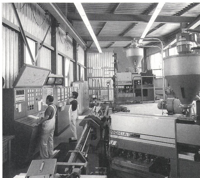
Bild 6 Kettenlinie- Trocken- vernetzungsanlage Ansicht mit Leit- stand und Drei- fachextrudern
