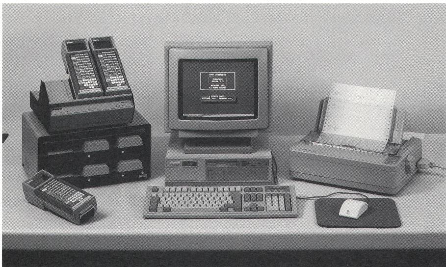
Bild 4 Konfiguration des gesamten Ablesesystems «z'enerdat»
