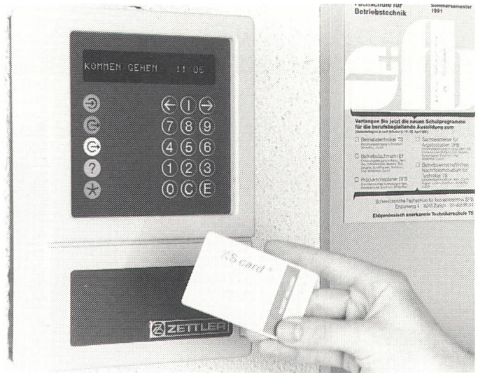
Bild 2 Die Funktionen Zutrittskontrolle und Zeiterfassung werden oft in das gleiche System integriert
