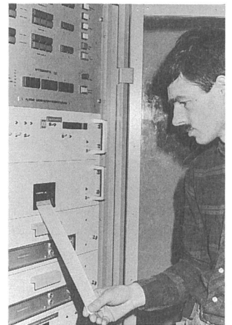
Die bei der Erdbebeninstrumentierung des Kernkraftwerks Beznau registrierten Werte lagen am 30. Dezember 1992 an der Grenze der Ansprechschwelle und stellten damit einen sicheren Reaktorbetrieb nicht in Frage
