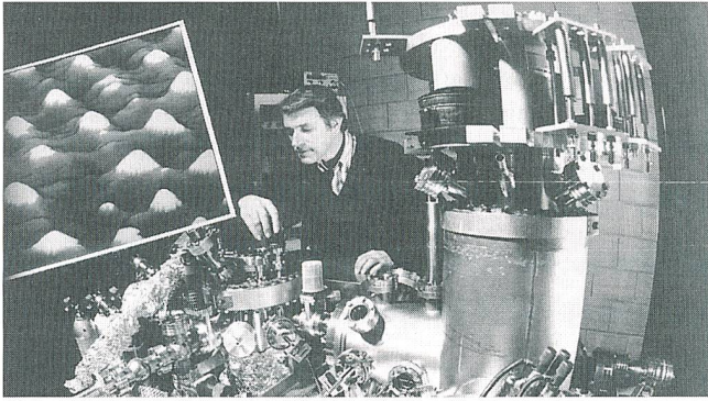
Tiefemperatur-Raster-Tunnelmikroskop und elektronisch aufbereitete Abbildung von leuchtenden, in eine Goldoberfläche eingebetteten C_{60} -Molekülen
