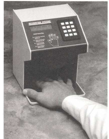
Bild 2 Handgeometrie-Erkennungsgerät Das Bild zeigt ein Gerät von Recognition Systems.
