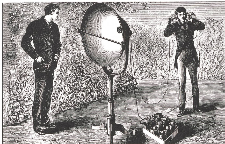
Bild 18 Photophon von Bell und Tainter: Vibrationen der Sendermembrane werden mit Lichtreflexen an den Empfänger übermittelt und dort gebündelt und verstärkt abgehört (1881).
