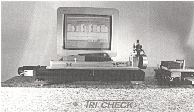
Prüfstand für Lasertriangulationssensoren
