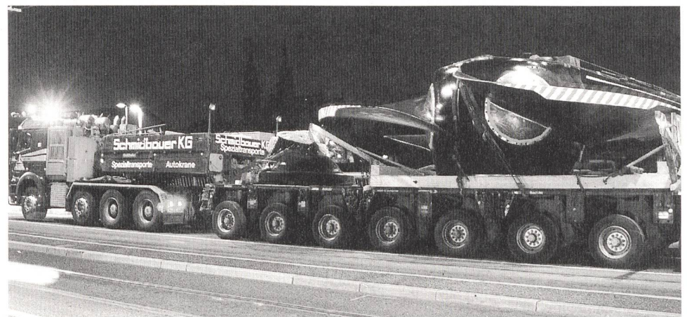
Neues Turbinenlaufrad auf der nächtlichen Anfahrt über die neue Wettsteinbrücke (Basler Münster im Hintergrund).
