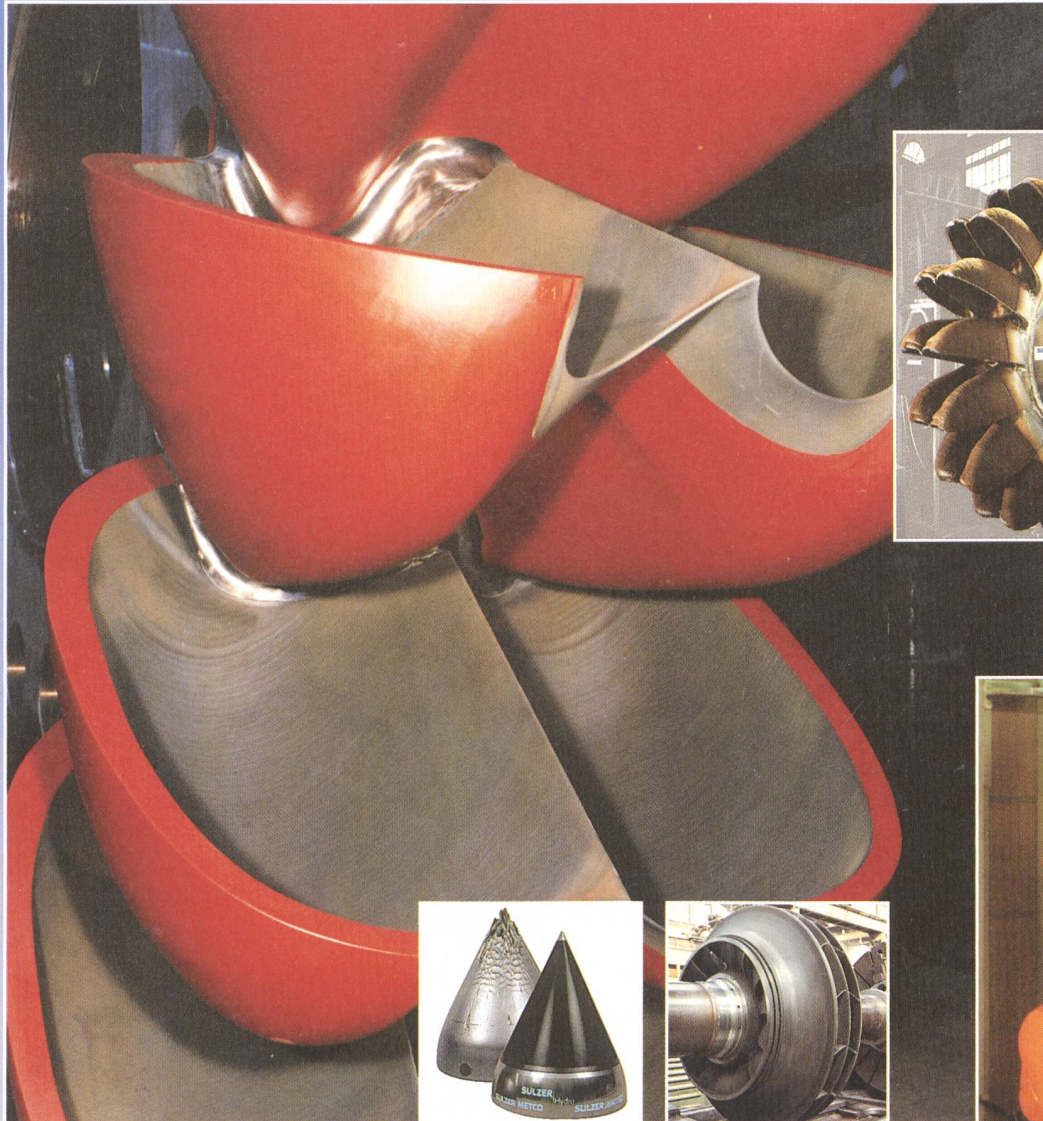
Beispiele für keramikbeschichtete Bauteile aus hydraulischen Maschinen
