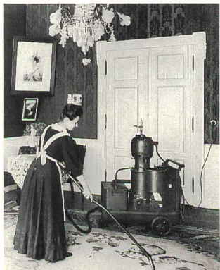
Bild 6 «Entstäubungspumpe», ein Staubsauger aus dem Jahr 1906.
