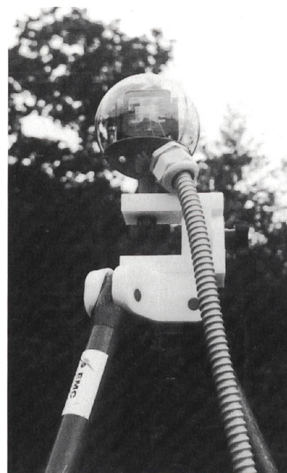
Bild 5 Das Ergebnis des Projektes: der neuartige Sensor EHO VLF (E-Feld, H-Feld, optische Übertragung, Very Low Frequency). Die integrierten Modulatoren bringen Vorteile für das Design.
