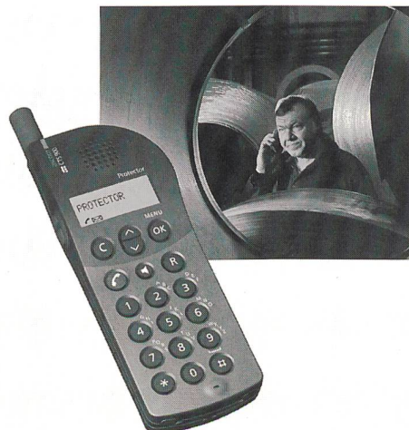
Taschenkommunikator für Personenüberwachung und Schnurlos-Telefonie (Bild ascum).
