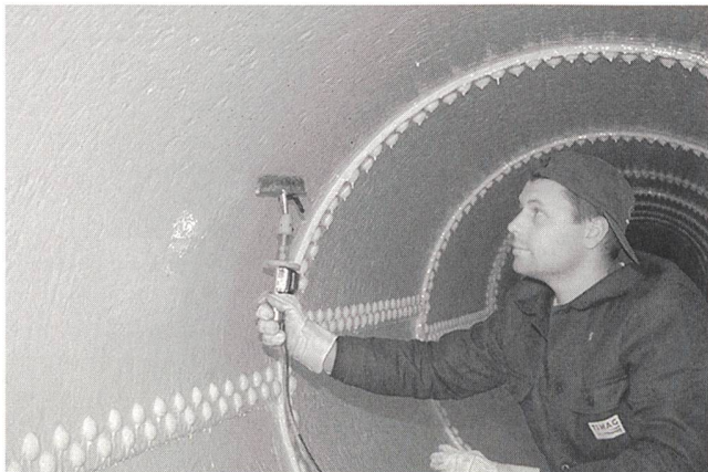
Bild 9 Überprüfung der Porenfreiheit mit Hochspannungsdetektor.
