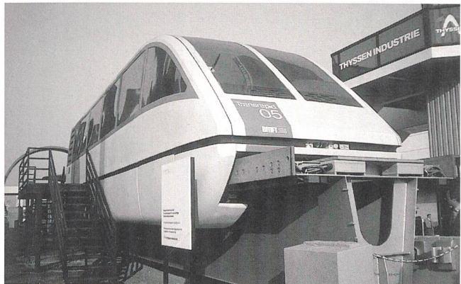
Transrapid mit magnetischem Trag- und Führungssystem.
