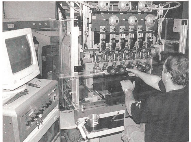
Modernste 6-Spindel-Wickelautomaten im Einsatz bei der w. frei ag.
