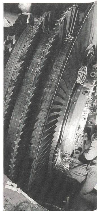
Gasturbine GT26 auf dem Prüfstand im ABB-Werk Birr.
