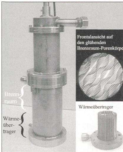
Bild 9 Öl-porenbrenner für Hausheizungen
