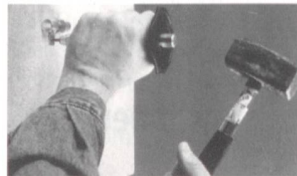
Der Bolzen sitzt fest im robusten Setzwerkzeug.
