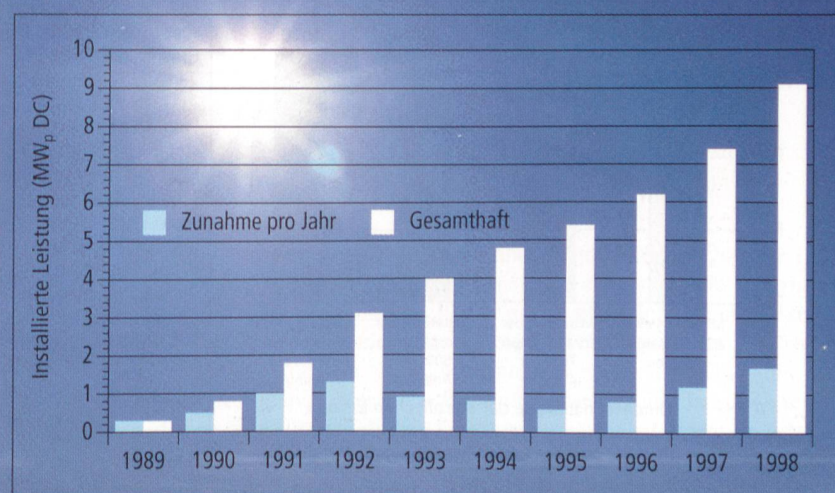
Bild 1 Jährlicher Zuwachs sowie kumulierte Leistung bei PV-Anlagen im Netzverbund. Ende 1998 waren 9,1 MW p installierte Leistung am Netz. Der positive Wachstumstrend der letzten beiden Jahre setzte sich weiterhin fort; die 1998 installierten 1,7 kW p entsprechen einem neuen Rekord.
