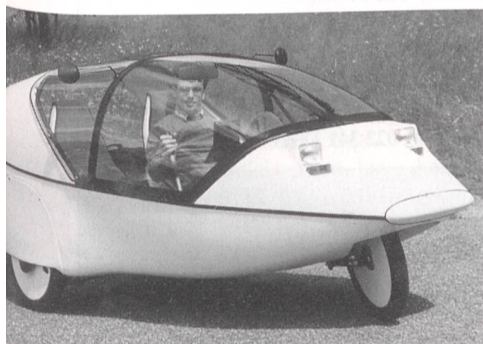
Das völlig unkonventionelle Fahrzeug Twike/S-Lem bietet zwei Personen Platz, die durch zusätzliches Treten die Reichweite etwas erhöhen können. Die Kombination von Leichtbau mit leistungsfähigem Antrieb verhelfen ihm zu guten Fahrleistungen. Die Bedienung erfordert allerdings Eingewöhnung.
