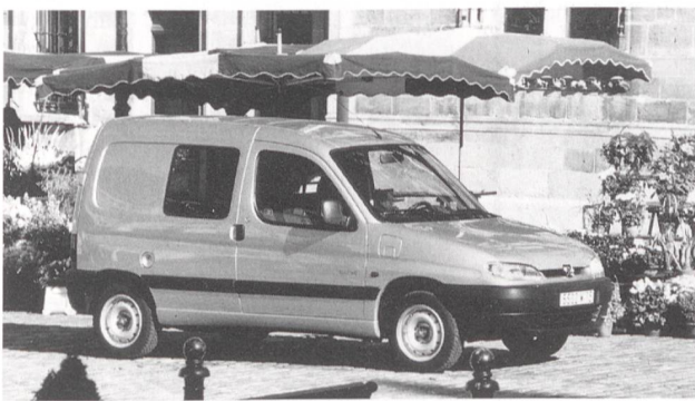
Die technisch weitgehend identischen Modelle Partner von Peugeot (links) und Berlingo von Citroën (rechts) des PSA-Konzerns sind mit ähnlicher Antriebstechnik wie die Personenwagen-Modelle 106 bzw. Saxo électrique ausgerüstet, die aber für das höhere Gesamtgewicht etwas verstärkt und mit einigen zusätzlichen Batterien ergänzt wurden. Dank günstiger Plazierung der Batterien unter dem Laderaum ist der Nutzraum der Elektroversionen praktisch gleich wie bei den konventionell angetriebenen Fahrzeugen. Auch diese Modelle verfügen über eine automatische Parkbremse. Für den Kaufentscheid vieler Interessenten hilfreich dürfte das neue Angebot von Peugeot zur Batteriemiete sein.
