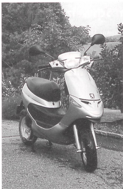
Scoot'elec von Peugeot. Der erfolgreiche Elektroller zeichnet sich durch ausgezeichnete Fahrleistungen in der Stadt aus. Höchstgeschwindigkeit 50 km/h, Reichweite rund 40 bis gegen 60 km, einfache Bedienung, Ladedauer etwa 2 Stunden.
