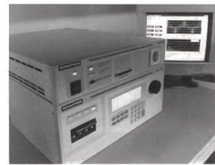
Analysator auf DSP-Basis für Normprüfungen
