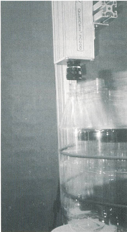
Bild 2 Qualitätskontrolle von PET-Flaschen
