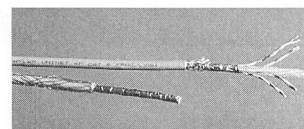
Cat.6-Kabel Uninet 6602 mit bis zu 300 MHz Impedanzverlauf
