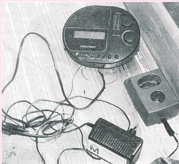
Radio mit defektem Zuleitungskabel setzt Baugerüst unter Spannung. Un poste de radio au câble défectueux met un échafaudage sous tension.
