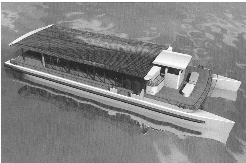
Der MobiCat (Länge 33 m), mit dem erstmals der Schritt zur kommerziellen Nutzung von energieautonomen Solarschiffen vollzogen wird, soll im Frühsommer 2001 einsatzbereit sein.
