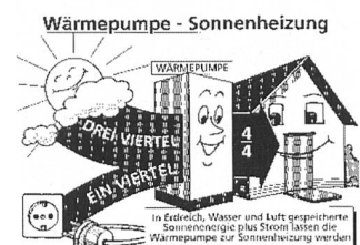
Die Wärmepumpe nutzt Sonnenwärme.
