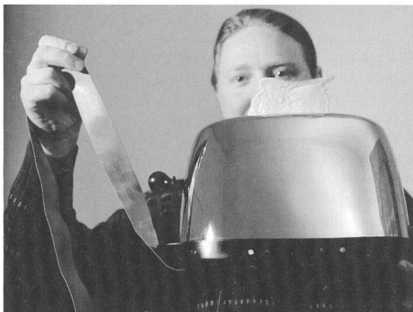
(si) Dieser Toaster ist ausschliesslich über das Internet zu bedienen. Was aussieht wie eine unsinnige Erfindung, ist jedoch tatsächlich ein grosser Schritt in der Entwicklung mobiler Internetanwendungen. Eingebaut ist ein mobiler Server, mit dem auch einfachste Haushaltsgeräte übers Web ferngesteuert werden können. Der telefonkartengrosse Mini-Server, der mit der zugehörigen Software schnell und einfach zu programmieren ist, kann aber genauso komplexe Industrieanlagen kontrollieren und steuern. (Siemens-Pressebild)
