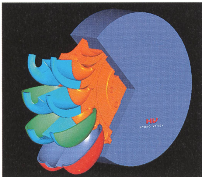
Bild 3 HIWELD™, die einzelnen Becher-teile, die auf eine geschmiedete Scheibe angeschweisst werden, sind in unterschiedlichen Farben gekennzeichnet.
