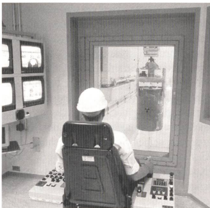
Der Kranführer beschickt das Lager mittels Fernbedienung in einem geschützten Nebenraum.
