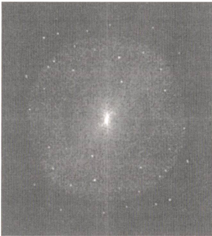
Fig. 3 Filigrane (amplifié) avec template, dans la magnitude de la transformée de Fourier. La tâche centrale (basses fréquences) concentre la majeure partie de l'énergie de l'image, le disque correspond au filigrane (fréquences moyennes), et les points sont les points du template.
