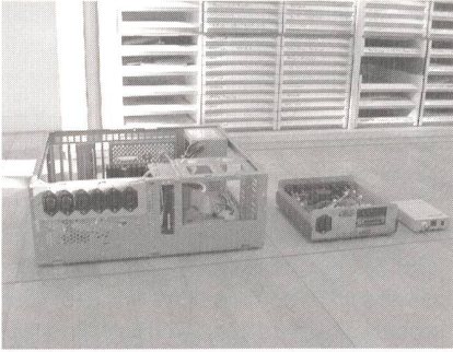
Bild 5 Linux-Server (links) mit Schaltboxen (rechts)
