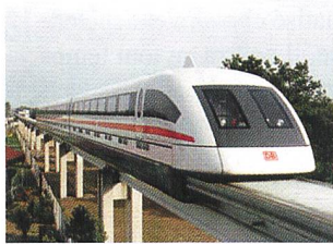
Die Magnetschwebbahn Transrapid erreicht eine Spitzengeschwindigkeit von 400 km/h.
