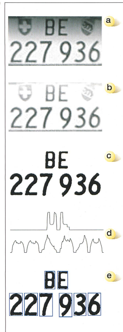
Bild 5 Reinigen des Bildes, Separieren der Zeichen a: Originalbild; b: Grauwertkorrektur; c: Zeicheninformation ohne störende Objekte; d: vertikale Projektionen; e: separierte Zeichen
