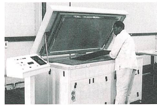
Südafrikanischer Arbeiter ver-schweisst ein PV-Panel (Bild nrel).
