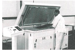
Südafrikanischer Arbeiter ver-schweisst ein PV-Panel (Bild nrel).
